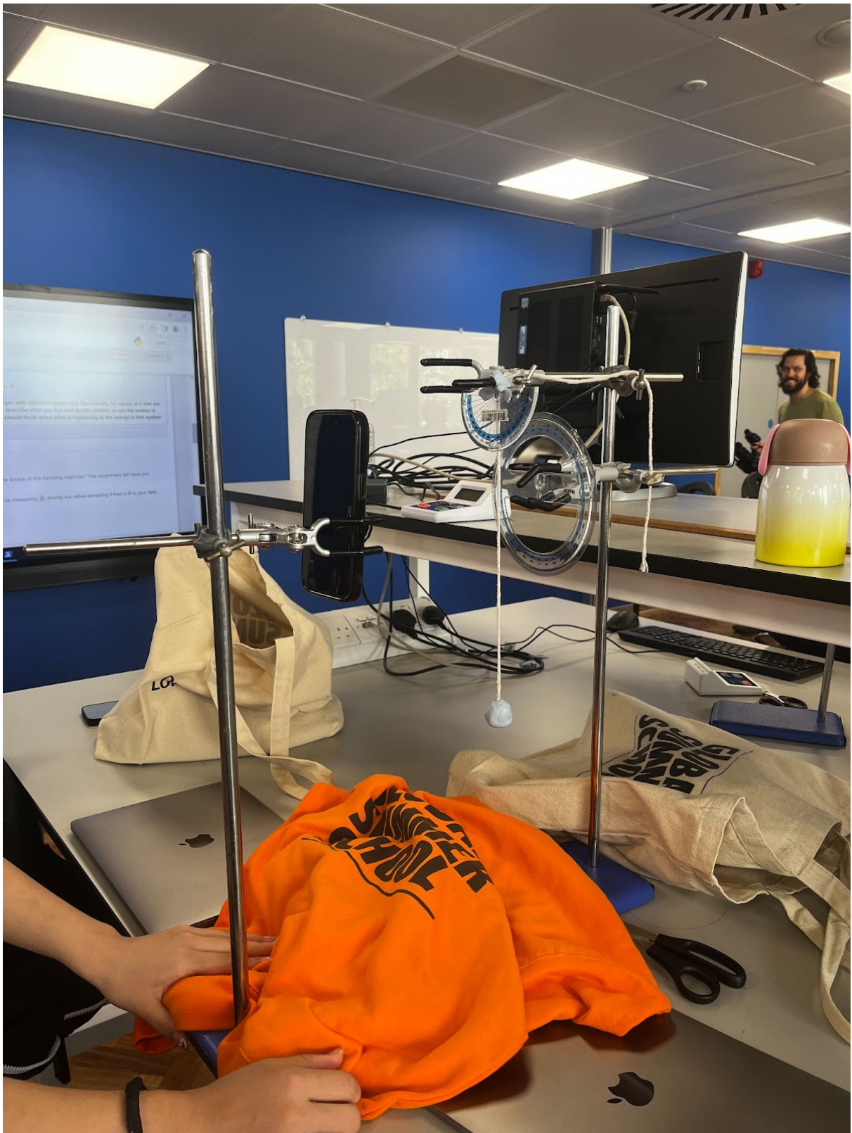
振り子の減衰振動について調べた実験。正確性を高めるためスマートフォンで運動を録画した。
